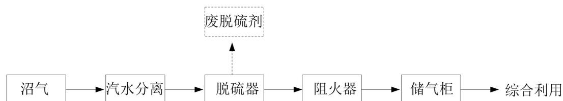
图 2.3-5 沼气处理流程图
