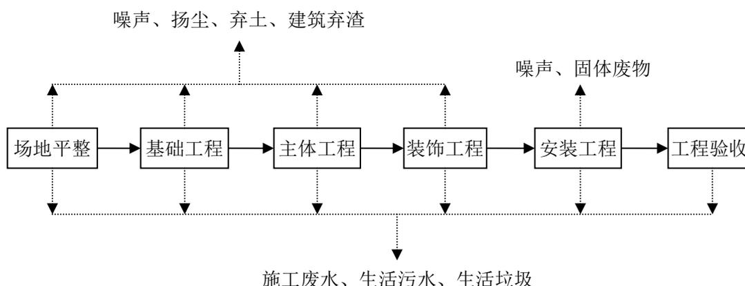
图 2.3-1 项目施工期主要污染环节示意图
