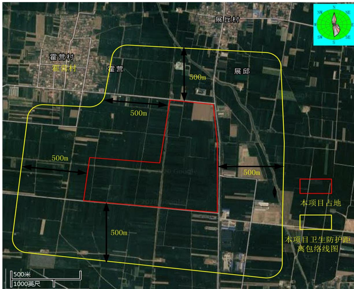
附图五 卫生防护距离包络线图
