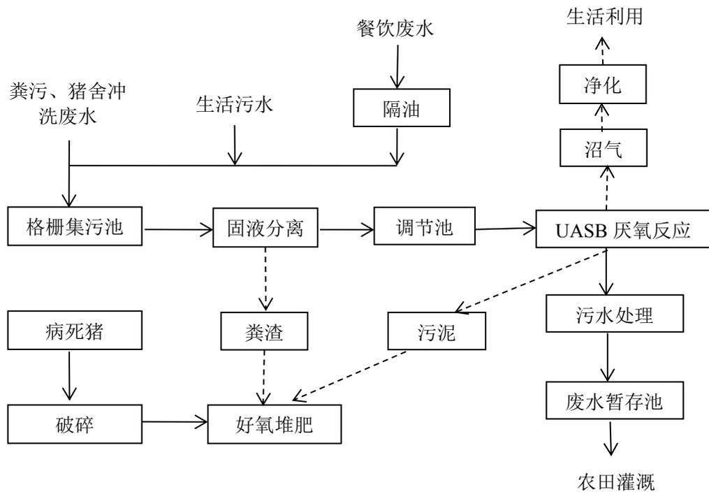
图 2.3-3 项目粪污处理工艺流程图
