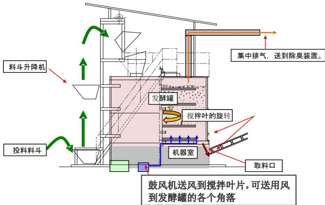
图 2.3-4 密闭式高温好氧发酵罐结构示意图
