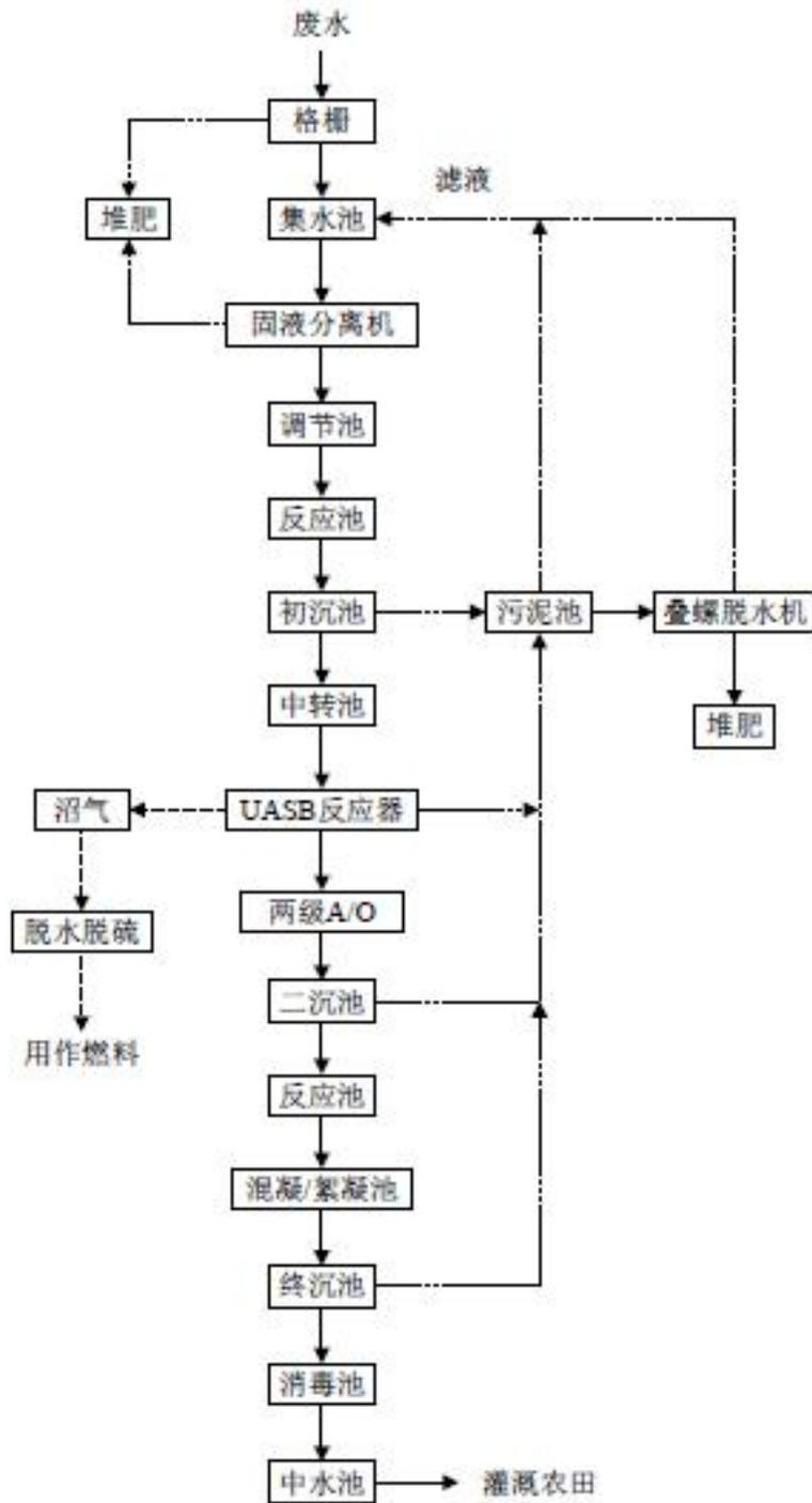
图 5.2-1 废水处理工艺流程图
