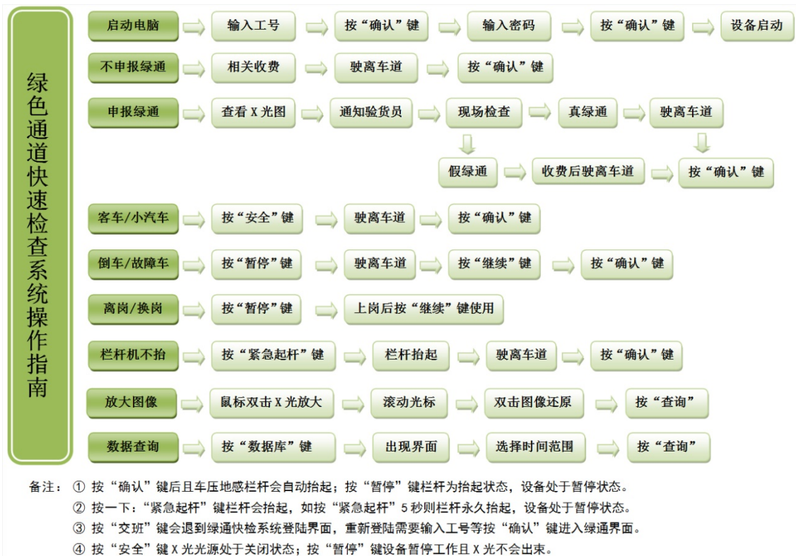
图 9-7 绿通辐射成像系统操作指南
