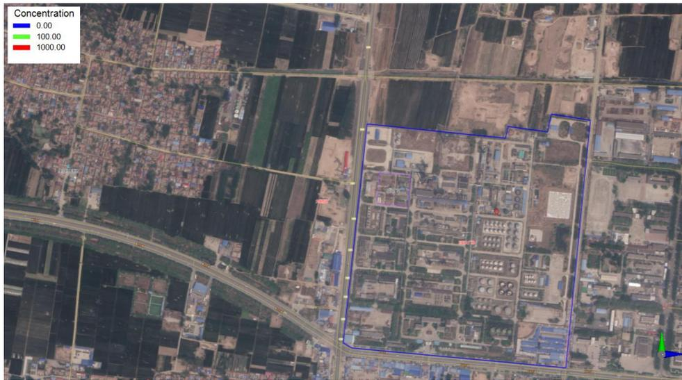
图 6.4-30 盐分（溶解性总固体）瞬时泄漏 100d-3650d 时的污染晕图
