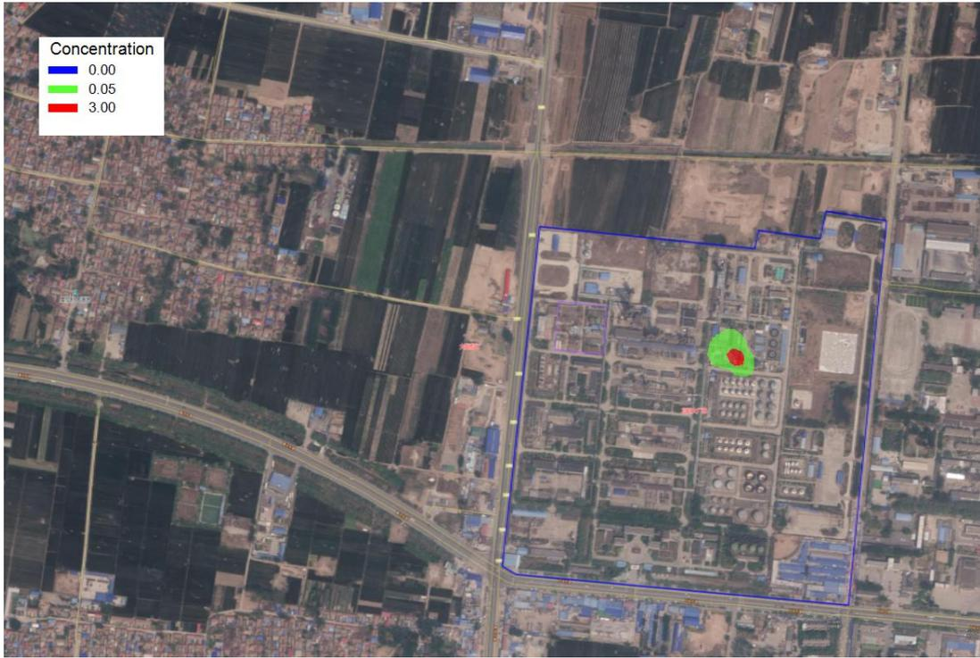
图 6.4-18 COD<sub>Mn</sub>连续恒定泄漏 100d 时的污染晕图
