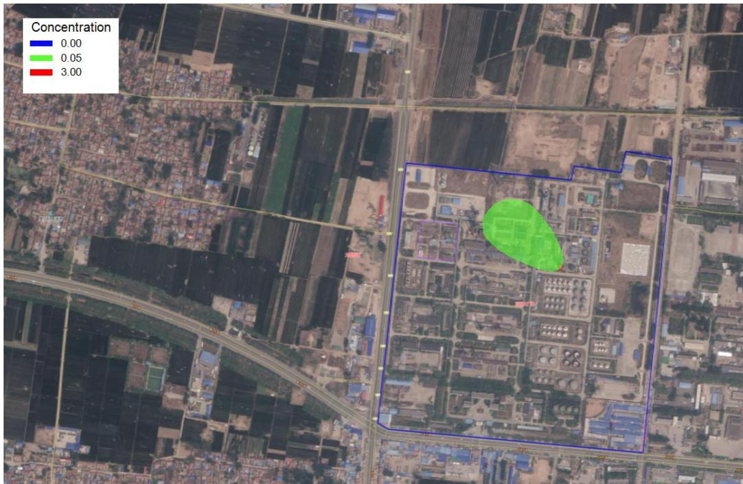
图 6.4-19 COD<sub>Mn</sub>连续恒定泄漏 1000d 时的污染晕图
