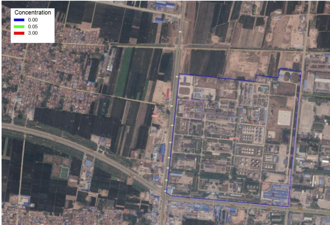
图 6.4-20 COD<sub>Mn</sub> 连续恒定泄漏 3650d 时的污染晕图
