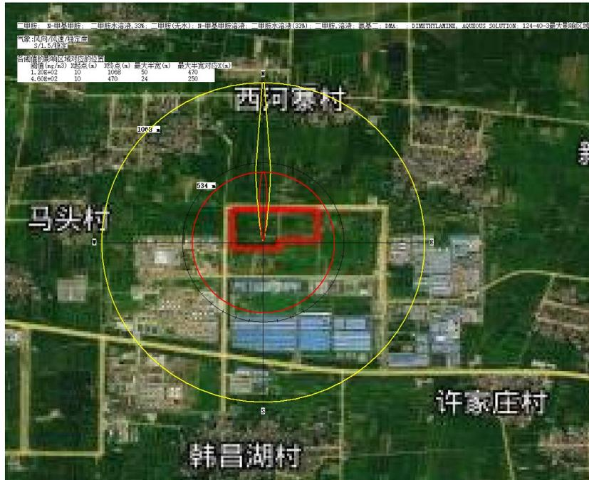
图 1.8-7 最不利气象条件下二甲胺水溶液泄漏时超过阈值最大轮廓线
