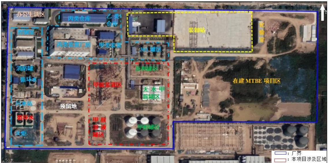
本项目超级吸氨器位于甲胺装置区东北角，氨水储罐、二甲胺水溶液储罐位于甲胺溶液罐区，具体见右图。
