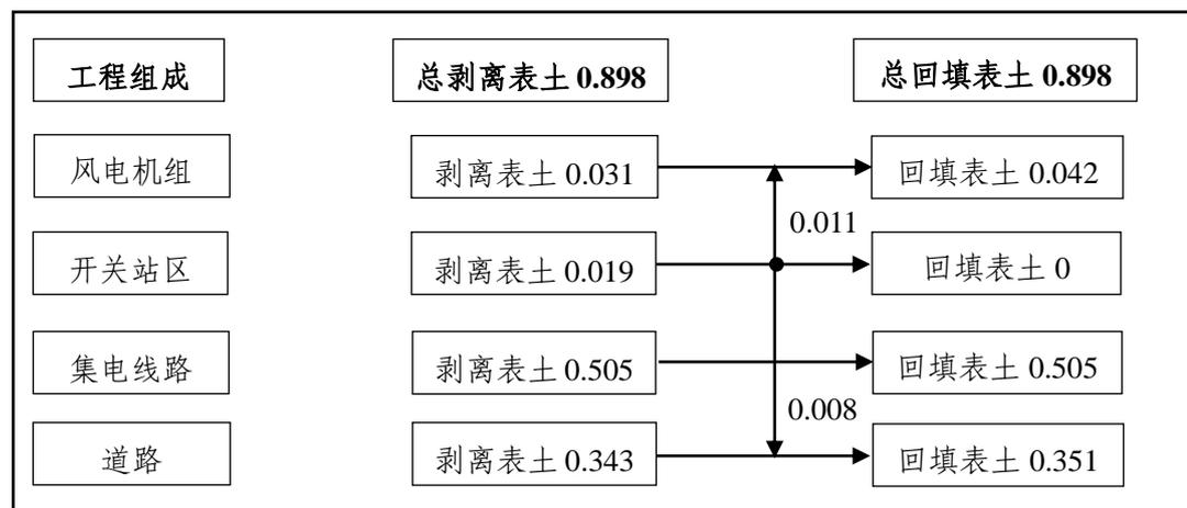
图 1 表土平衡流向图 单位：万 m<sup>3</sup>
