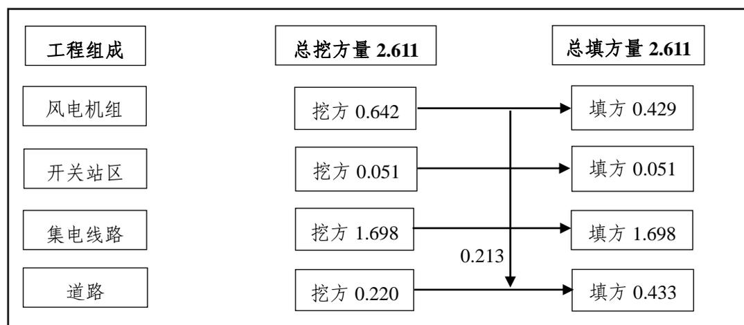
**图 2 土石方平衡流向图 单位：万 m<sup>3</sup>**
