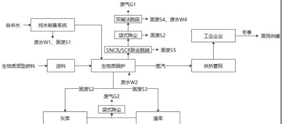
图5 锅炉供热生产工艺及产污环节流程图
