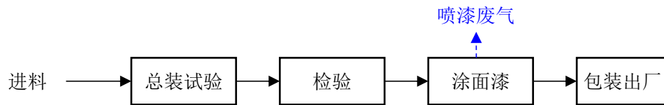
图 4.2-13 绞车架生产工艺流程及产污节点图
