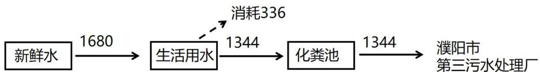
图 1 水平衡图 单位：t/a
