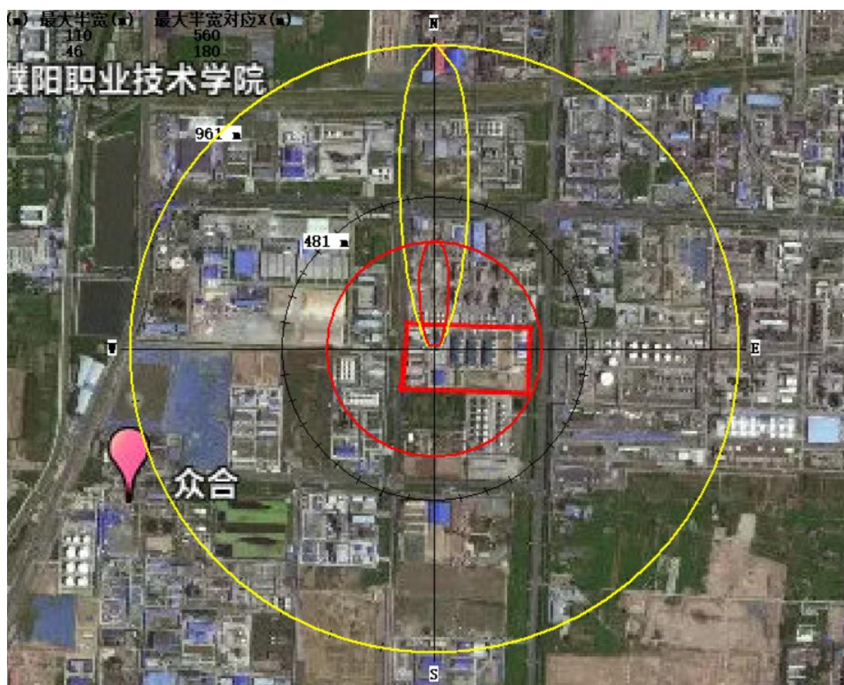
图 7.7-6 最常见气象条件下氯化亚砷储罐泄漏超过阈值最大范围图
