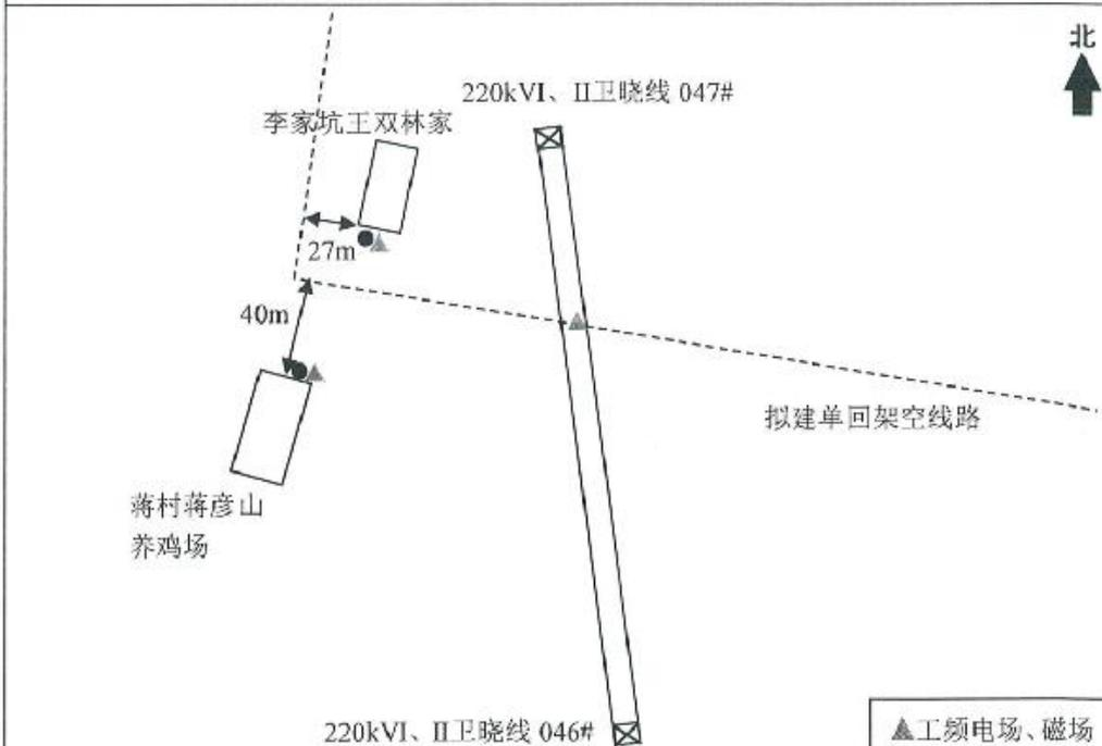
图 2 李家坑王双林家、蒋村蒋彦山养鸡场及钻越 220kV I、II 卫晓线处检测示意图
