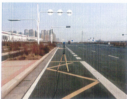
110kV 较场变测电缆段断面电磁环境检测照片
