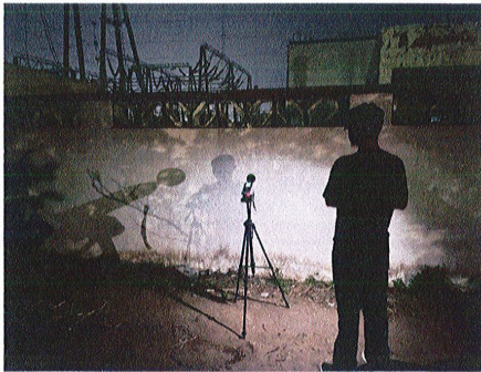
振兴 220 千伏变电站北侧厂界 5#夜间噪声检测照片
