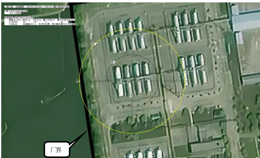
图 7-9 最不利气象条件下污染物 SO<sub>2</sub> 超过阈值最大轮廓线
