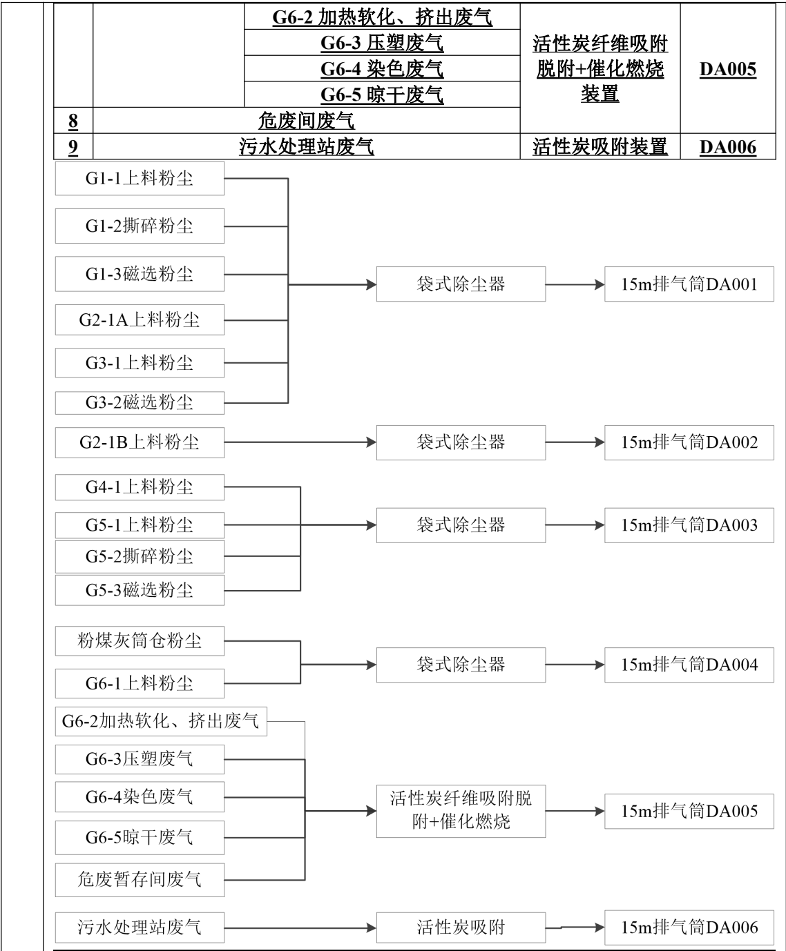
图 10 废气走向图
