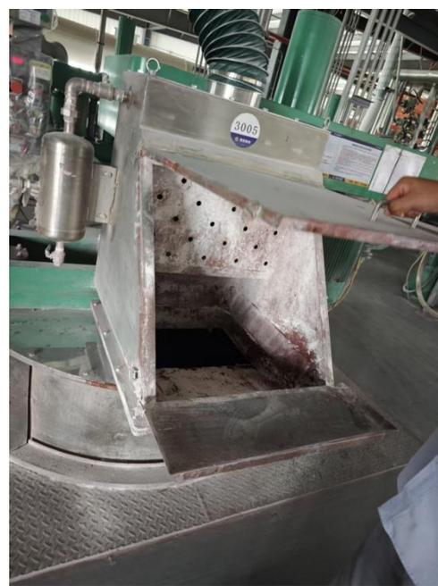
图 4-3 粉料投料密闭式集气管道
