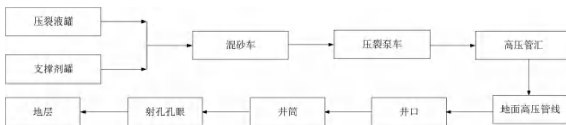
图 3.2-3 压裂施工时液体流动过程
