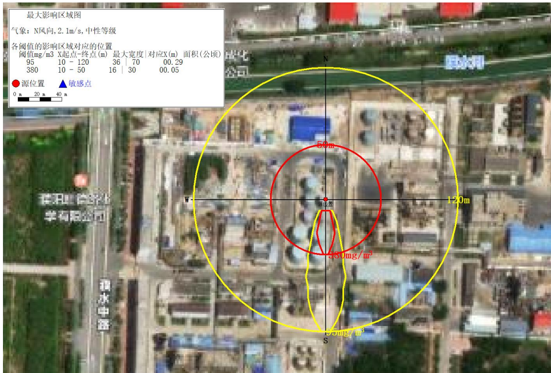
图 8.2-12 次生 CO 常见气象条件下 CO 预测浓度超过阈值的最大影响区域图
