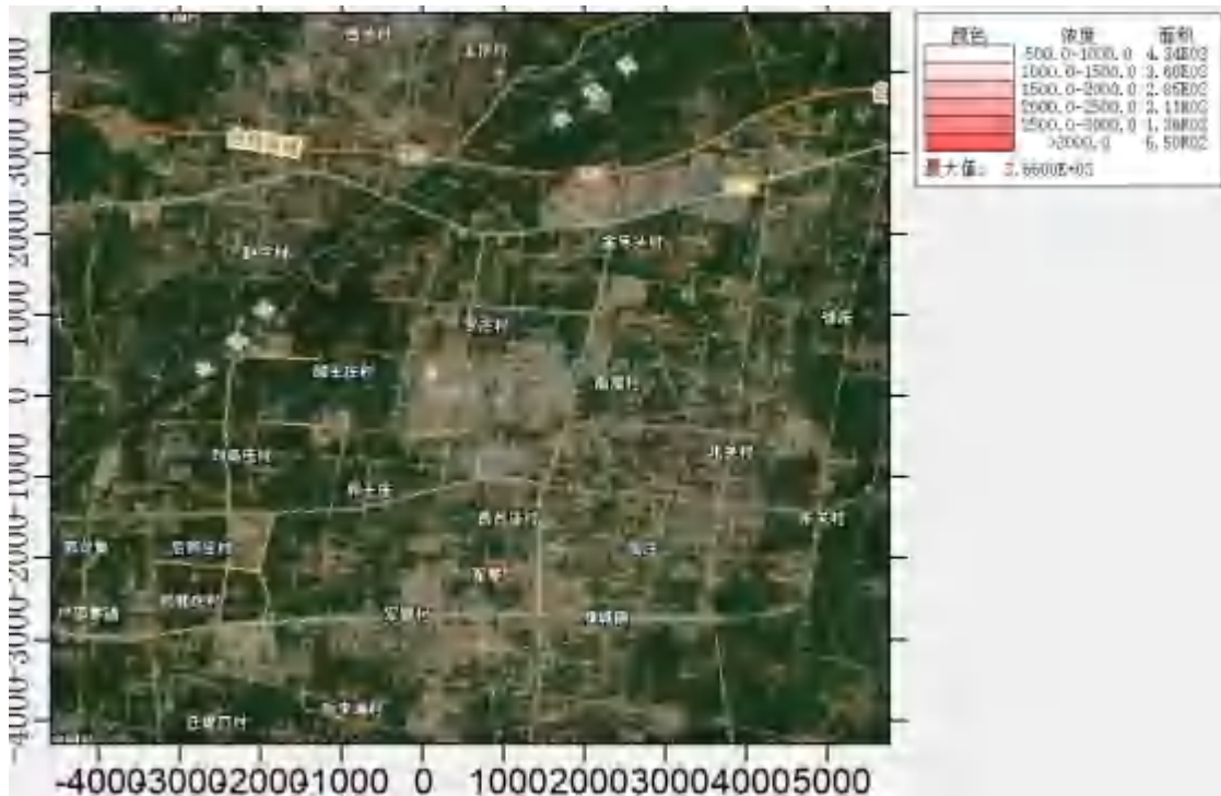
图 8.1.7-2 最不利气象条件下石油气污染网格点计算结果分布图
